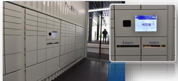
Beispielanlage mit einem Bedienterminal mit Touch-Screen und einem RFID oder NFC Leser
